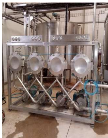
Foto 37 - Hidro Ciclone 5 motores
