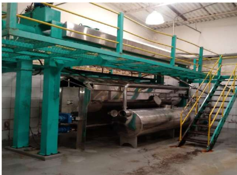
Figura nº 27 - Filtro Prensa com 35 placas FONTE: Acervo das unidades industriais da empresa
