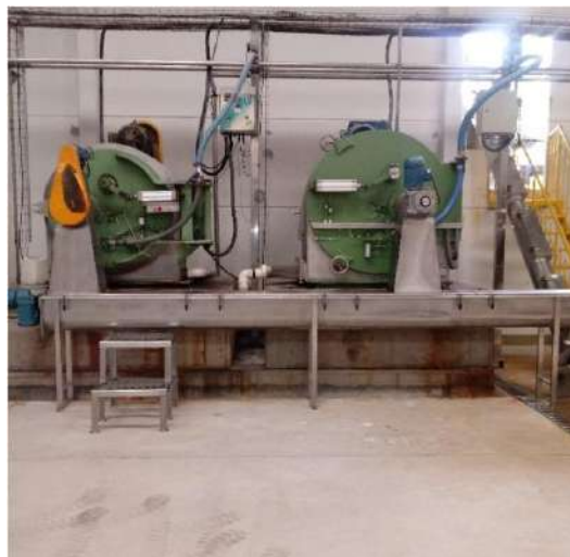
Figura nº 39 – Piller 1500 Ton/h 40 CV FONTE: Acervo das unidades industriais da empresa
