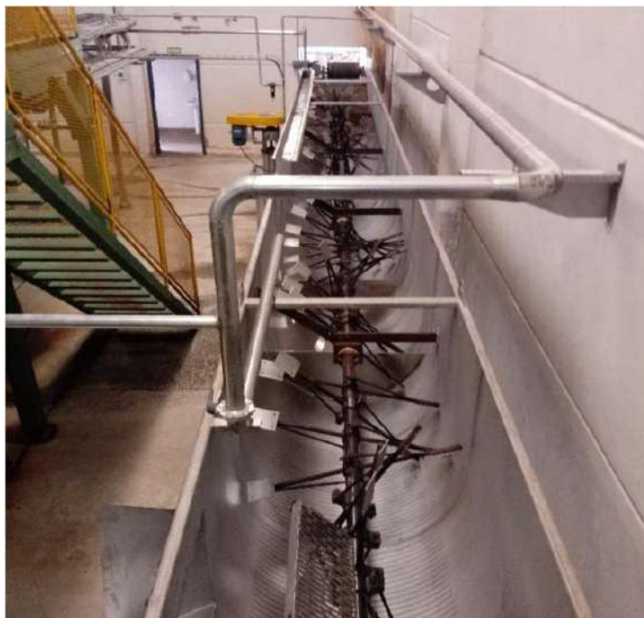
Figura nº 23 - Lavador de Raiz com motor 10 CV FONTE: Acervo das unidades industriais da empresa
