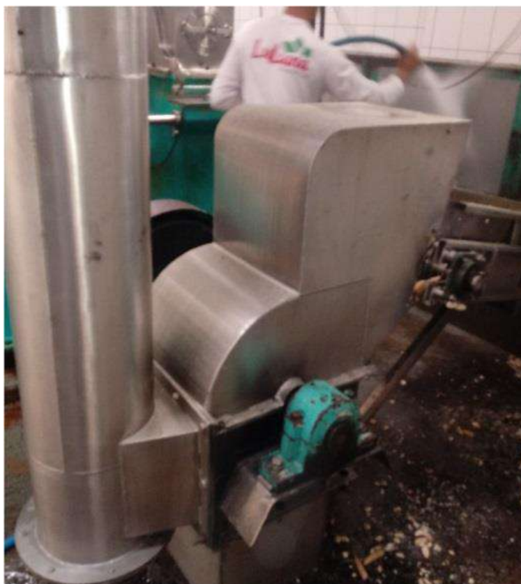
Figura nº 24 - Picador de Raiz motor 20 CV
