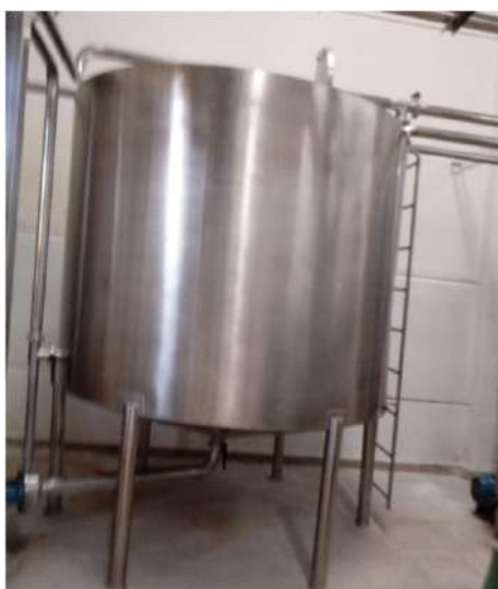
Figura nº 36 - Tanque Pulmão 10 mil Litros.
